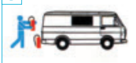
Eingesetzte Feuerlöscher nicht mehr aufhängen. Feuerlöscher neu füllen lassen
